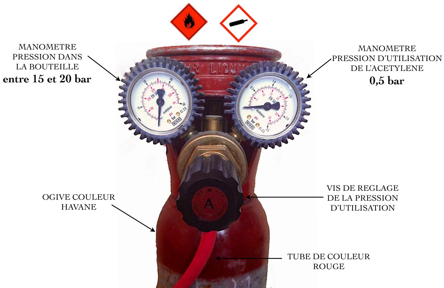
Manomètre indiquant la pression dans la bouteille d'acétylène.
