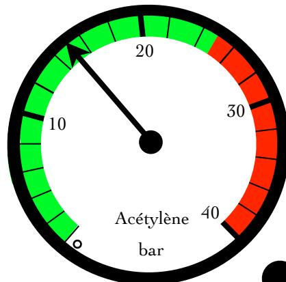
Manomètre indiquant la pression d'utilisation de l'acétylène.
